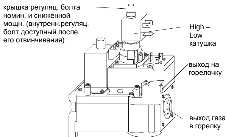
Рис. 4 VR 4601 QB 2001 с катушкой High – Low с выходом к зажигающей горелочке
